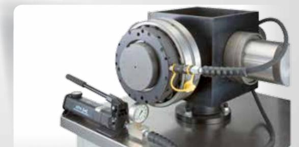
Estrazione della bussola di smontaggio tramite la ghiera idraulica
